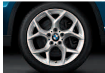
18" Leichtmetallräder Y-Speiche 322 8Jx18 mit Bereifung 225/45
