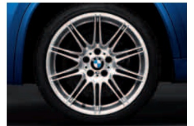
19" M Leichtmetallräder V-Speiche 225 M 8Jx19 mit Bereifung 225/40 vorn 9Jx19 mit Bereifung 255/35 hinten
