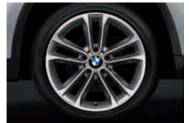
18" Leichtmetallräder Doppelspeiche 421 8Jx18 mit Bereifung 225/45
