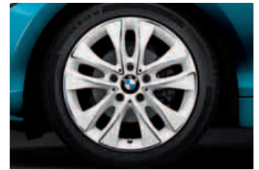
17" Leichtmetallräder V-Speiche 412 Bicolor weiß / hochglanzgedreht 7½Jx17 mit Bereifung 225/45
