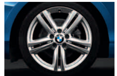
18" Leichtmetallräder Sternspeiche 386 M 7½Jx18 mit Bereifung 225/40 vorn, 8Jx18 mit Bereifung 245/35 hinten
